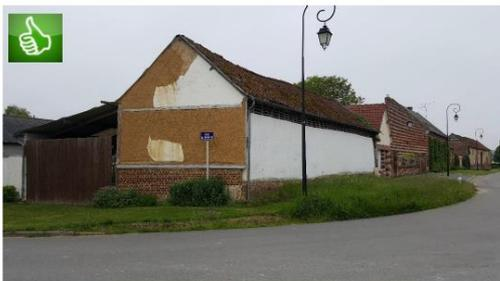
Exemple de construction où le torchis a été remplacé par de la tôle
