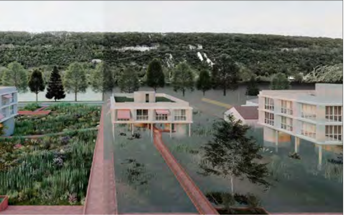
Voie douce et passerelles piétonnes desservant les plots de logements, sur pilotis, un coeur d'une prairie humide inondable.
